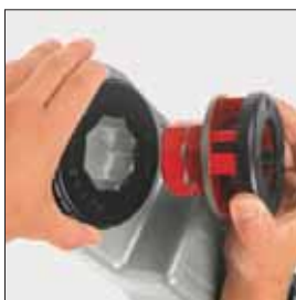
Установка резьбонарезных головок
