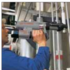
Система из двух выключателей: выключатель легкодоступен в любом рабочем положении
