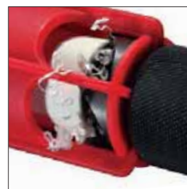
Мощный резец, ориентированный на систему пресс-фитинга
