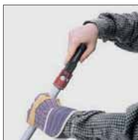
Простое снятие грата с использованием ручки
