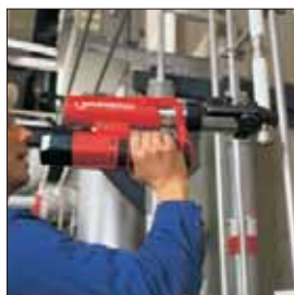
Система из 4-х выключателей: выключатель легкодоступен в любом рабочем положении
