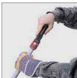
Простое снятие грата с использованием рукоятки
